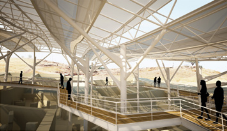
Çizim 5: İki katmanlı makas tasarımı, dikey taşıyıcı elemanlar ve yürüyüş yolu
