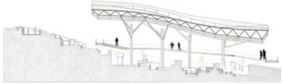
Çizim 8: Kuzey – güney yönünde kesit Taşıyıcı makasların tümü farklı profildedir
